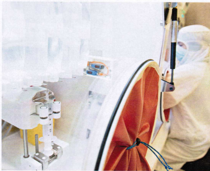
► Un préparateur (à droite) introduit les composants dans l'isolateur, puis le bras robotisé (au premier plan) entre en action.
